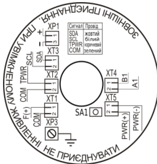
Рис. 4.4 – Вигляд схеми зовнішніх приєднань ПК-В з живленням від батареї (мікроспоживаючий)
