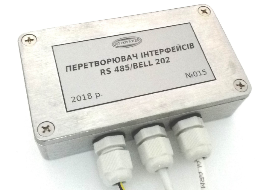
Рис.2 Зовнішній вигляд перетворювача інтерфейсів RS485/Bell202
