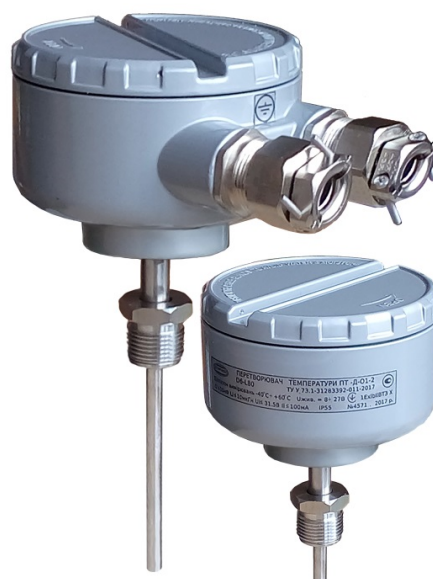
Рис. 2 – Зовнішній вигляд перетворювача температури ПТ-1-Д, виконання корпусу С. Пломба А- захисна пломба, яка перешкоджає доступу всередину корпусу перетворювача
