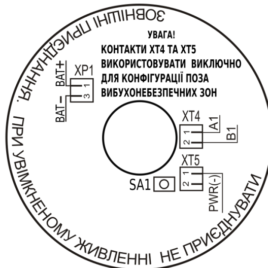
Рис. 4в – Зовнішні приєднання ПД-1-Р-А, ПД-1-Р-И, ПД-1-РН-А, ПД-1-РН-И (для конфігурування перетворювача в вибухобезпечній зоні)
