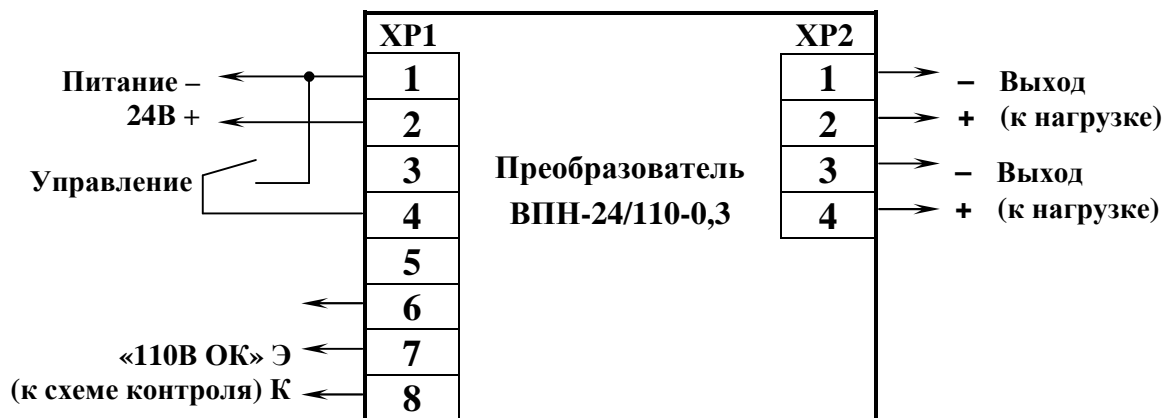
Рисунок 3.2. Внешние подключения преобразователя.
