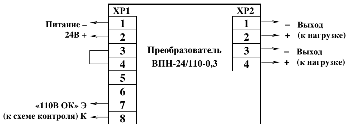
Рисунок 3.3. Внешние подключения преобразователя без использования сигнала управления.
