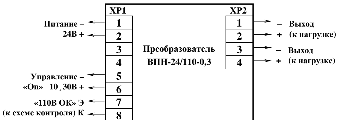
Рисунок 3.1. Внешние подключения преобразователя.
