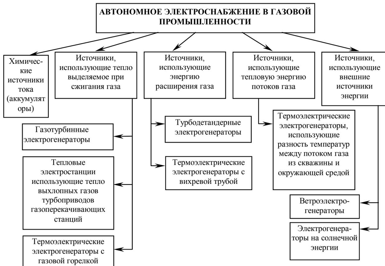
Рисунок 1 Автономные источники электроснабжения, используемые в газовой промышленности.
