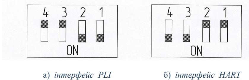
*Рис.1а - Положення перемикачів SB1 перетворювача температури ПТ-1-П в корпусі А*
