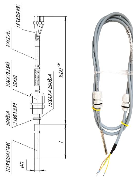
Рис. 3б – Зовнішній вигляд ПТ-1-Д виконання корпусу Г \*
