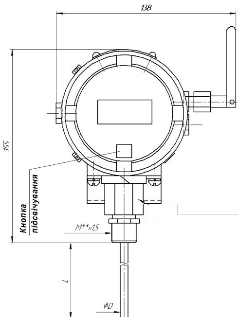
**Рис. 3г – Зовнішній вигляд перетворювачів ПТ-1-Д з автономним живленням та радіоінтерфейсом (корпус Д)**
