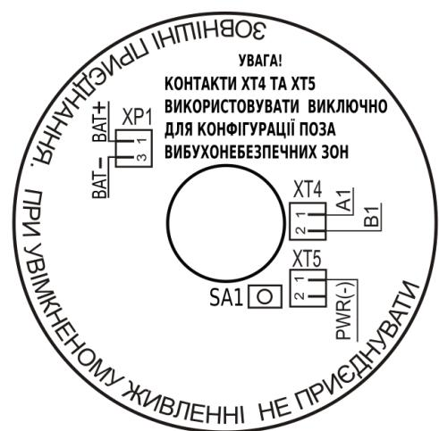
**Рис. 3д – Зовнішні приєднання перетворювачів ПТ-1-Д з автономним живленням та радіоінтерфейсом (для конфігурування у вибухобезпечній зоні).**
