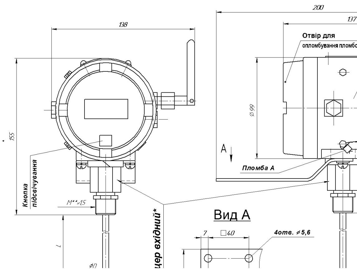
**Рисунок 12 - Габарити перетворювача ПТ-1-Д виконання в корпусі Д та схеми його пломбування**
