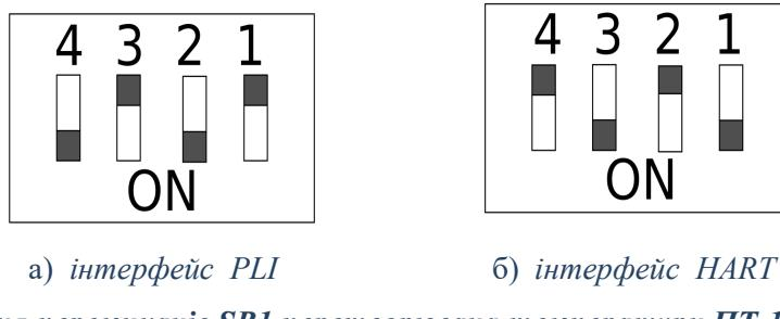
*Рис.1б - Положення перемикачів SB1 перетворювача температури ПТ-1-П в корпусі С*
