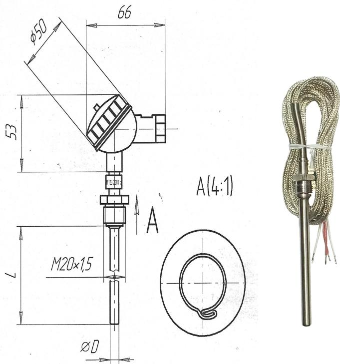
Рис. 3а – Зовнішній вигляд ТО Pt100 перетворювача температури ПТ-1-П, виконання корпусу А.
