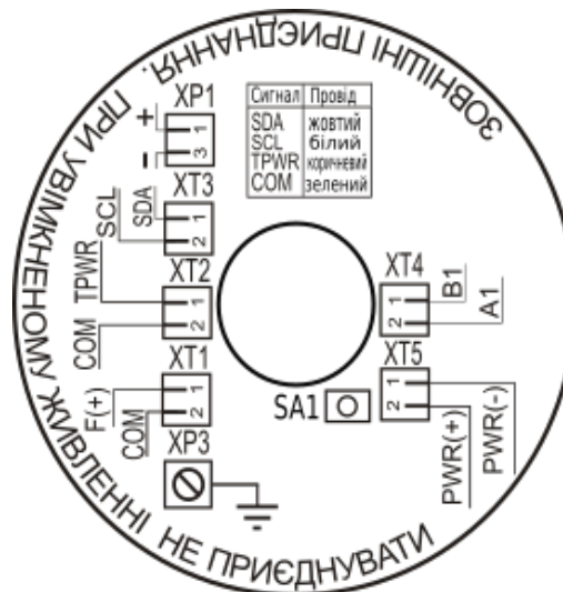
Рисунок 4.4 – Вид вигляду схеми зовнішніх приєднань ПК-В з живленням від батареї (мікроспоживачий)
