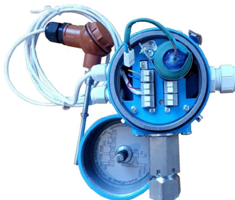
Обчислювачі ПК-В комплексу виконання 2 з автономним живленням з боку підключення батареї живлення
