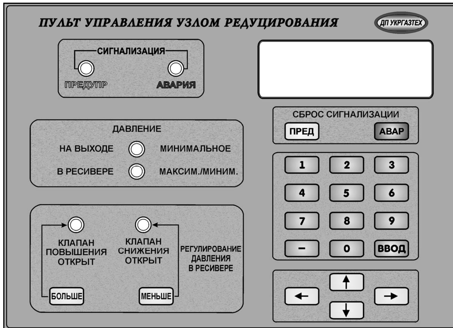
Рисунок 3 - Вид лицевой панели пульта управления Комплекса
