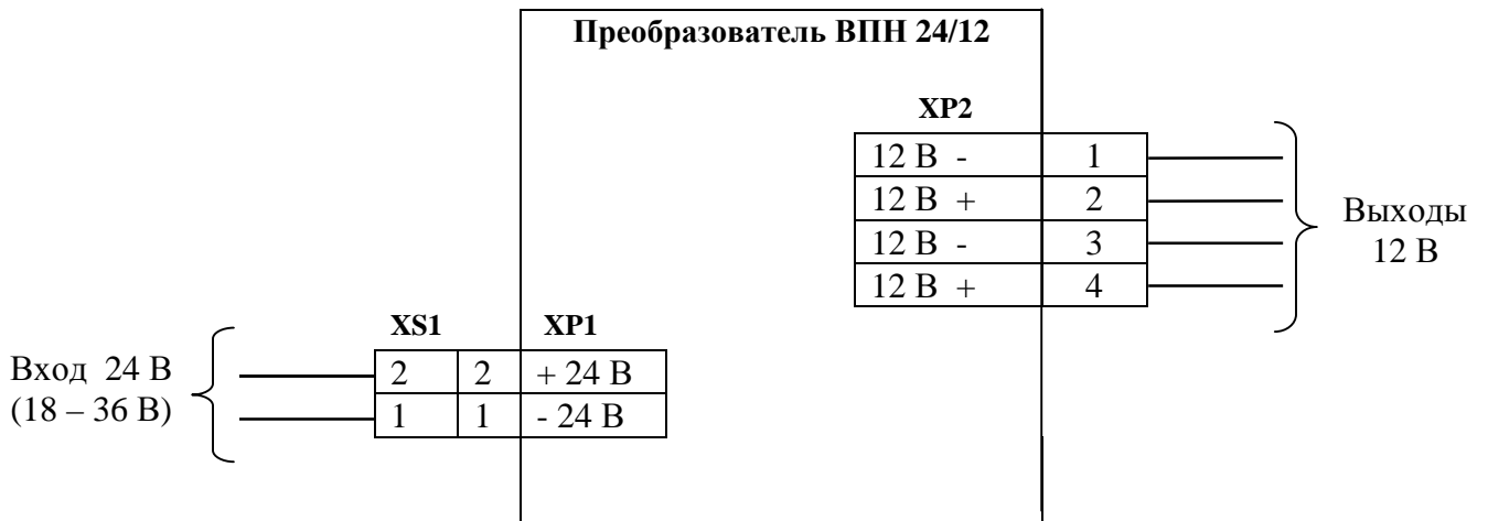
Рисунок 1 - Схема подключения преобразователя ВПН 24/12
